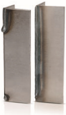
Een gelaste hoeknaad ter vergelijking. Standaard vlamboog (links): zeer snel voorlopend smeltbad, vlak voordat het vloeibare lasmetaal eruit valt. SpeedCold (rechts): compleet, veilig en snel gelast (35 cm/min).
