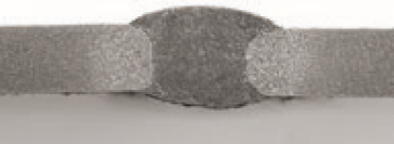
Optimaal, licht overwelfd naadbeeld zonder bindingsfouten – voor maximale spleetolerantie en spleetoverbrugging.
